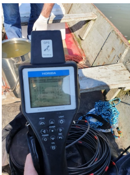
Figura 12: Registro da aferição dos parâmetros in situ com a sonda multiparâmetros Horiba U-50 e o disco de Secchi.
