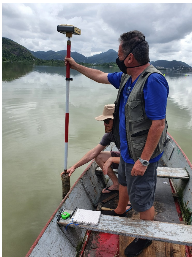
Figura 56: Aferição da altimetria do topo da estaca na primeira campanha de monitoramento.
