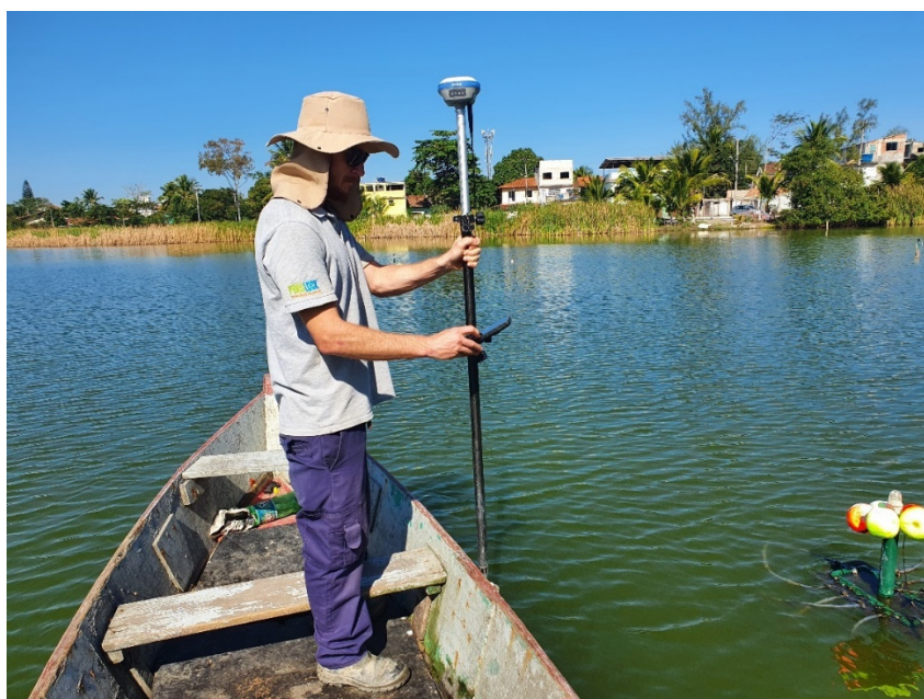
Figura 57: Aferição da altimetria do topo da estaca na segunda campanha de monitoramento.
