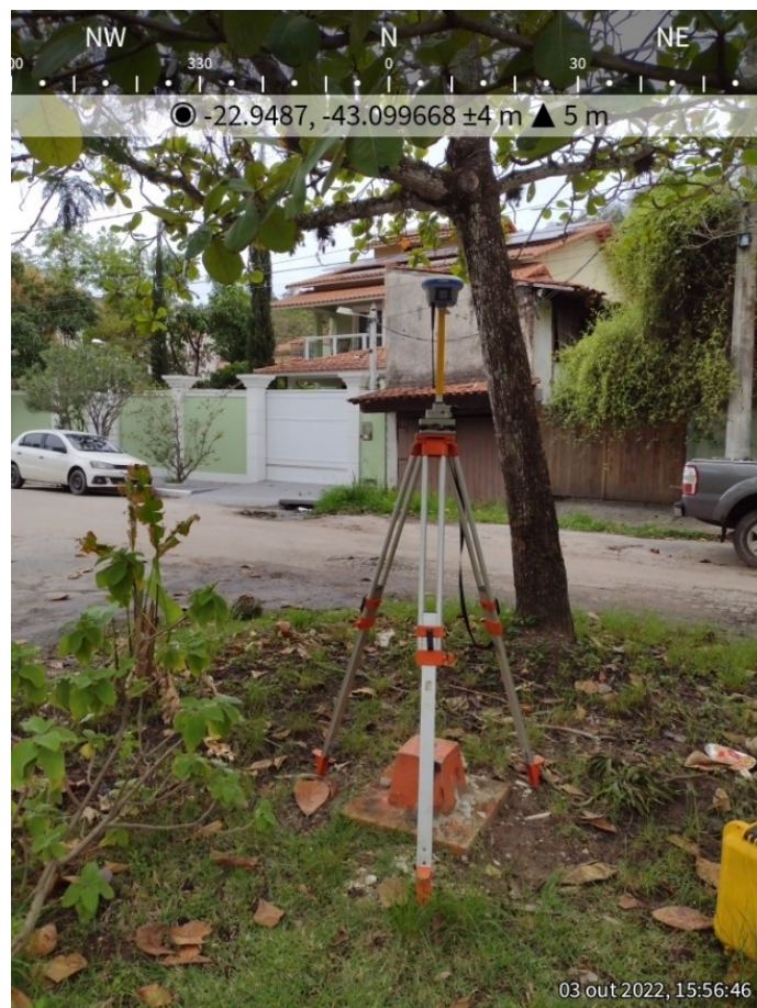
Figura 55: Definição do Marco base utilizado como referência.
