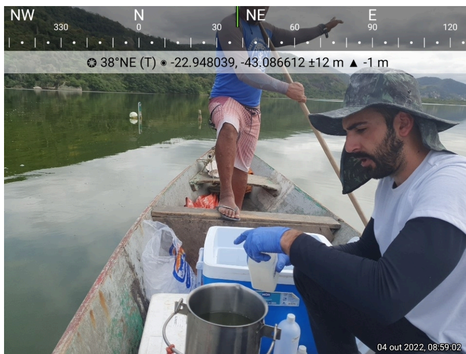
Figura 16: Coleta de água e transferência para o frasco na terceira campanha de monitoramento.
