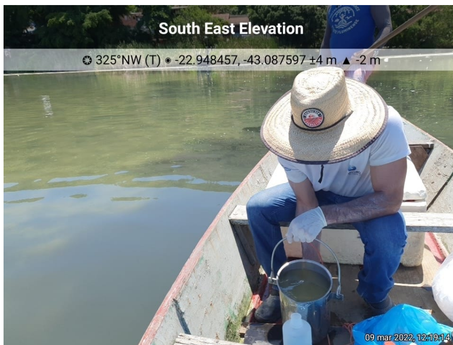
Figura 14: Transferência do material amostral para o frasco de armazenamento para envio ao laboratório de análises na primeira campanha de monitoramento.
