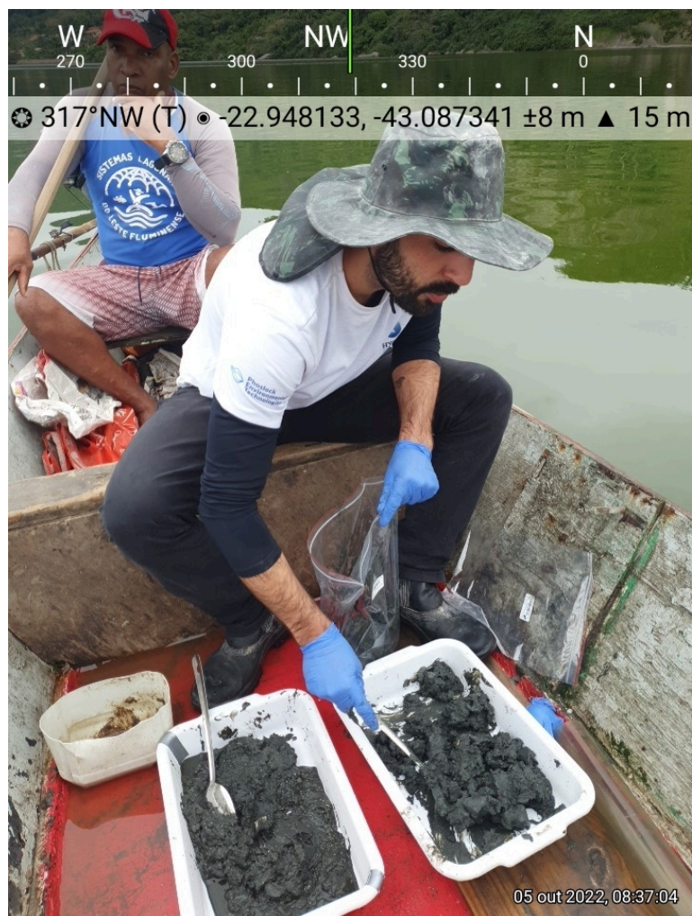
Figura 32: Transferência do material coletado para os sacos ziplock devidamente identificados para envio ao laboratório na terceira campanha de monitoramento.
