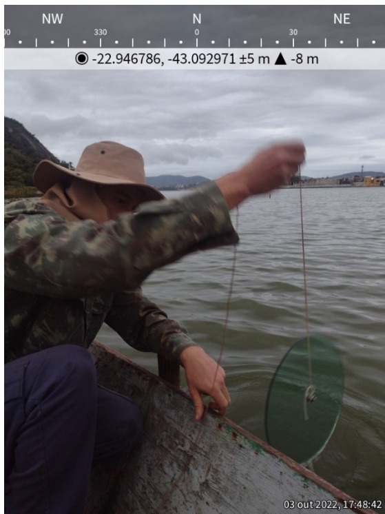
Figura 59: Aferição da altura da camada de lodo em relação ao nível d'água com a utilização do disco de acrílico.
