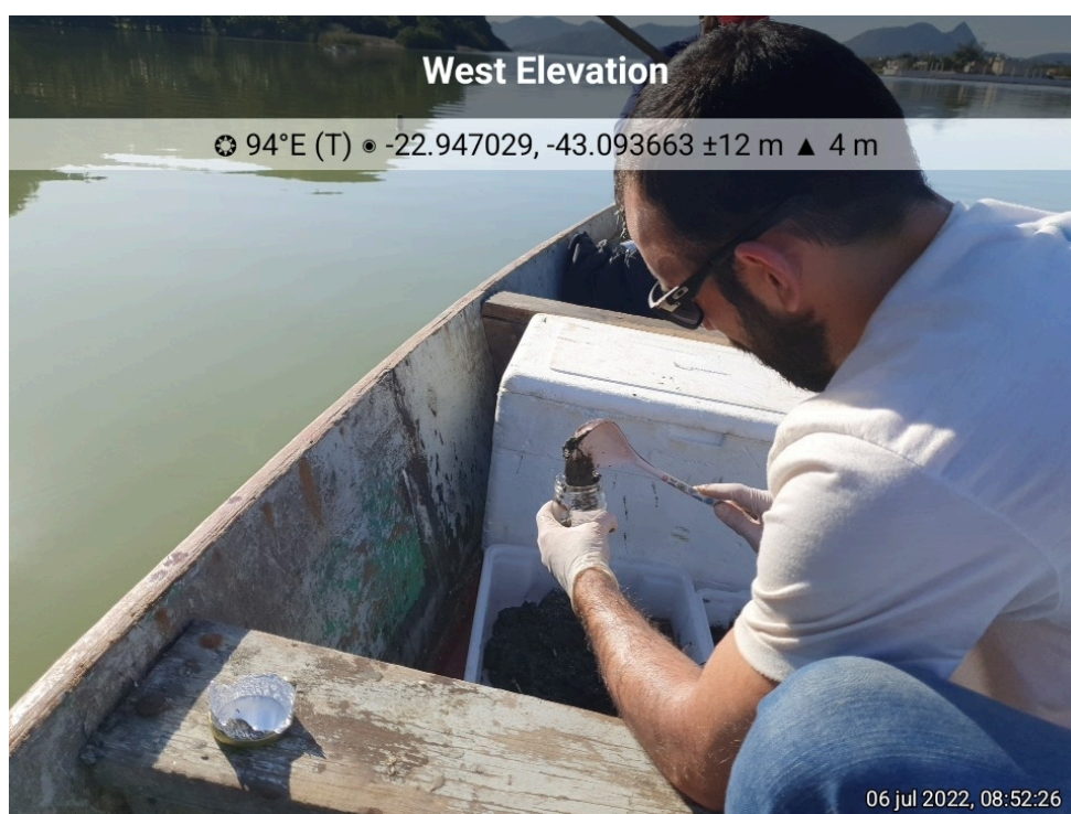
Figura 31: Transferência do material coletado para os frascos devidamente identificados na segunda campanha.
