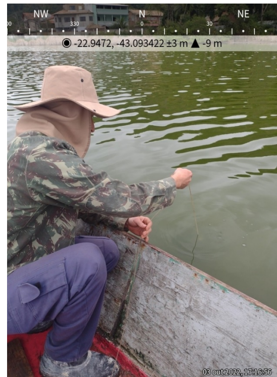
Figura 59: Aferição da altura da camada de lodo em relação ao nível d'água com a utilização do disco de acrílico.
